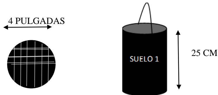
Figura 1. Diseño de recipiente para el análisis del valor del sensor y humedad por la metodología HG_RCG.
