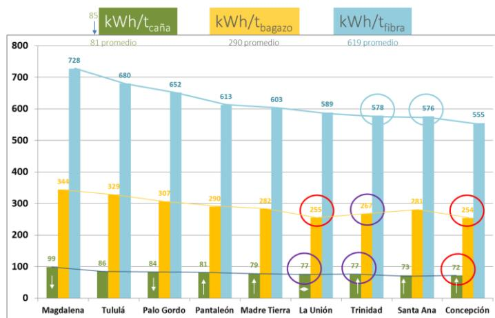
Figura 12. Generación total de energía eléctrica (kWh/t)
